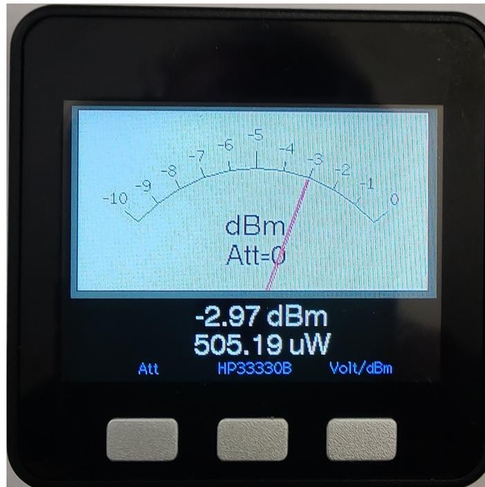
Ce wattmètre numérique utilise une sonde détectrice à diode de chez Hewlett Packard type HP33330B. Cette sonde possède une sortie de tension négative.
